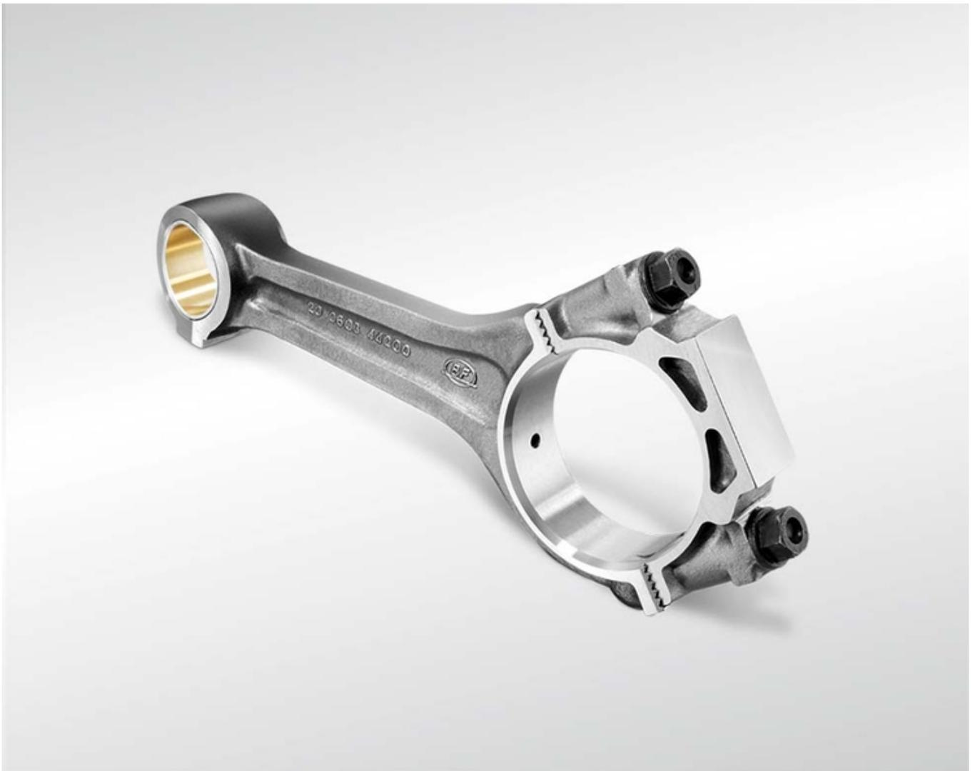
La biela está montada sobre la muñequilla del cigüeñal con un cojinete liso. La tapa del cojinete de biela se fija a la base de la biela con pernos de expansión. En la mayoría de los casos, la biela está perforada o diseñada con un canal de aceite moldeado para suministrar lubricante al bulón del pistón.
