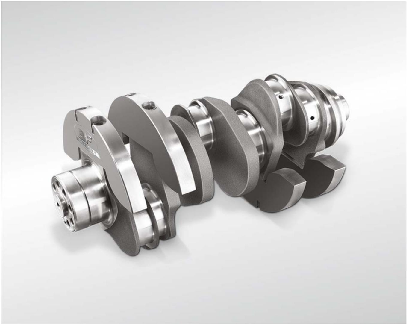
El cigüeñal debe soportar grandes cargas. Por un lado, está expuesto a grandes esfuerzos debidos a la flexión y la torsión. Además, se producen tensiones debidas a las vibraciones de torsión, ya que el cigüeñal se acelera y desacelera de forma constante e intermitente en su movimiento de rotación.
