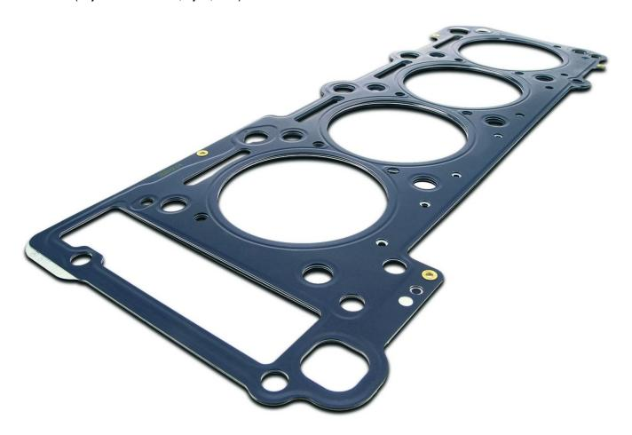
Además de la tarea de sellar entre sí y con el exterior los distintos medios del motor, como gases, agua y aceite, las juntas también sirven como elemento de transmisión de potencia. Por ejemplo, la junta de culata entre el bloque motor y el bloque de cilindros influye considerablemente en la distribución de la fuerza dentro de todo el sistema tensor y en las deformaciones resultantes de los componentes.
