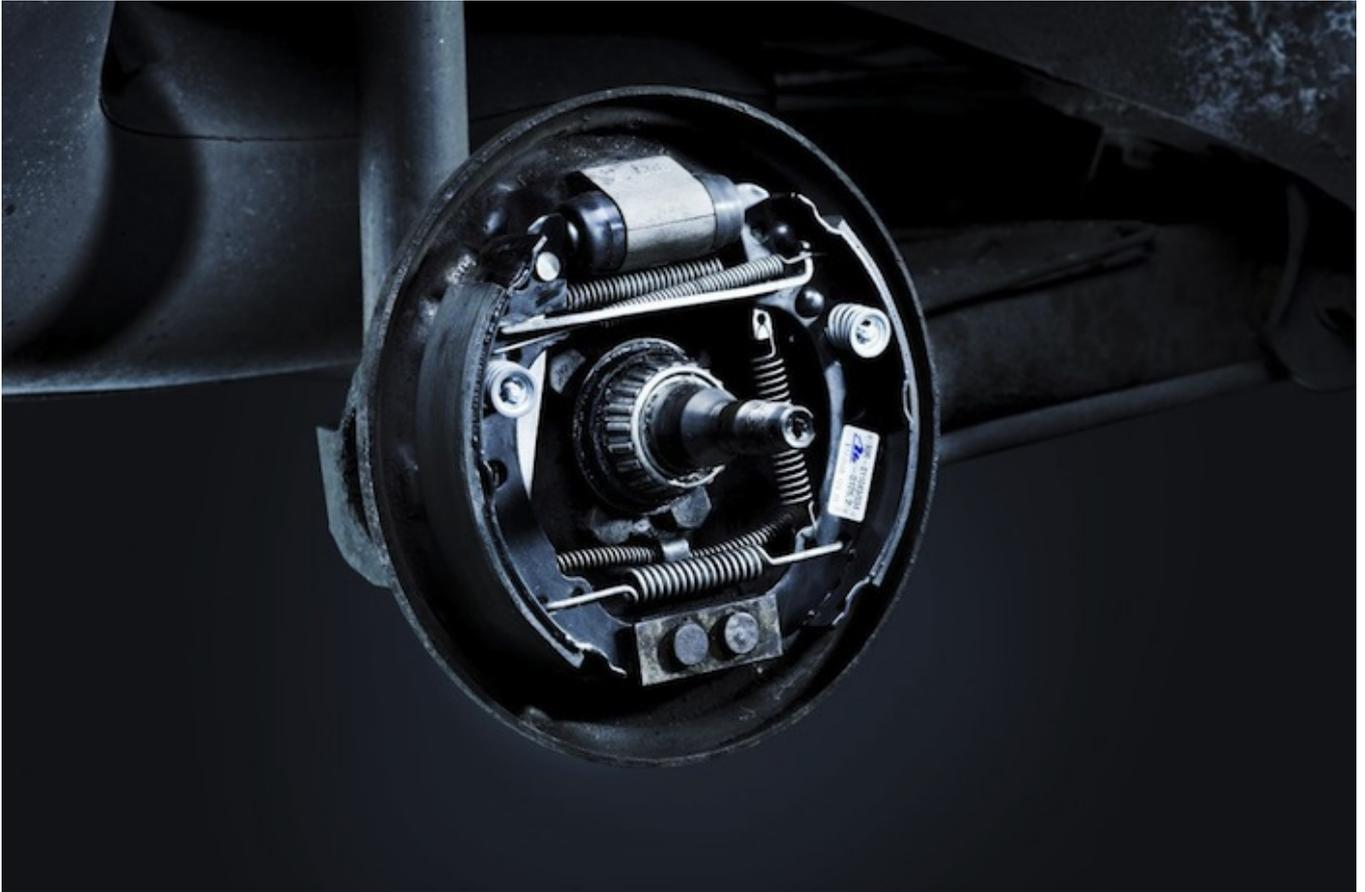
El cilindro de rueda es una de las piezas del vehículo relevantes para la seguridad. Debe comprobarse periódicamente su correcto funcionamiento en como parte de los trabajos de inspección. Cuando se sustituyen las zapatas o los tambores de freno, es aconsejable sustituir también los cilindros de rueda. Así se evitan reparaciones posteriores en poco tiempo.
